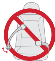
חגורות אגן עם לוח נעילה מוחזקת בתפרים ועם מגננון מתיחה שננעל רק במקרה של עצירה פתאומית.
